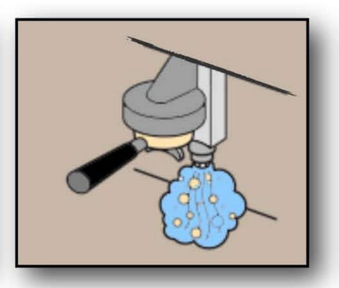
C: Siebträger einspannen und Maschine Rückspülen. ca. 5 mal in 15 sec. Zyklen mit start/stop
