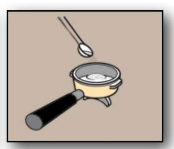
**B:** Reinigungspulver (ca. 4g) in den Blindfilter einfüllen
