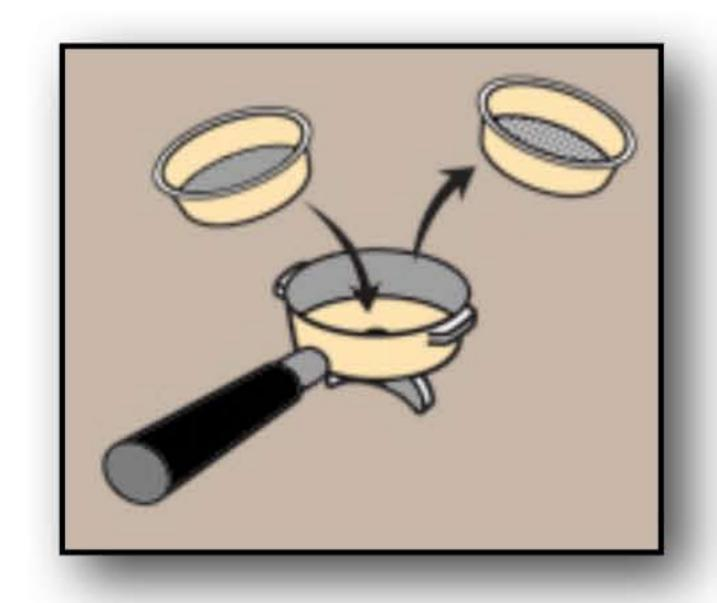
**A:** Normalen Filter gegen dem Blindfilter (Filter ohne Löcher) ersetzen
