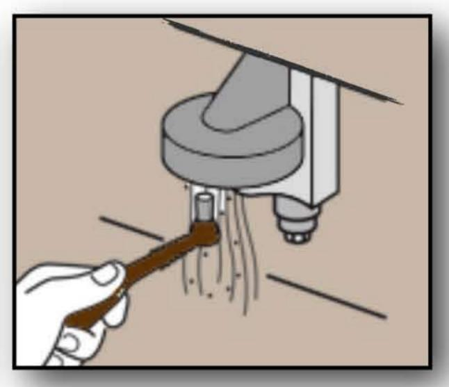
D: Siebträger entfernen und bei laufendem Wasser Gruppe mit geeigneter Bürste reinigen
